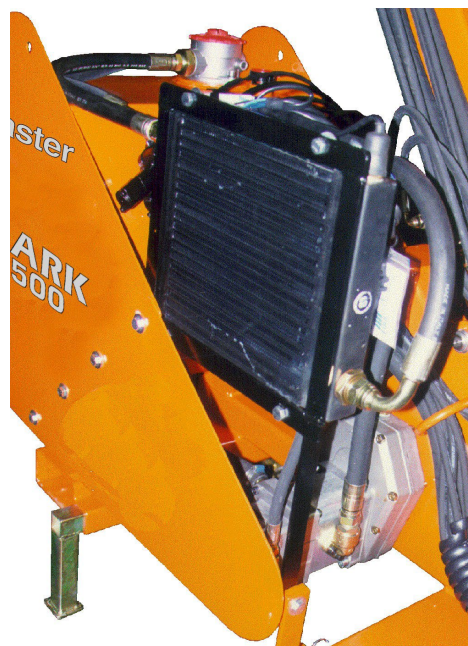
Fig. 9-3 Värmeväxlare med automatisk efläkt
